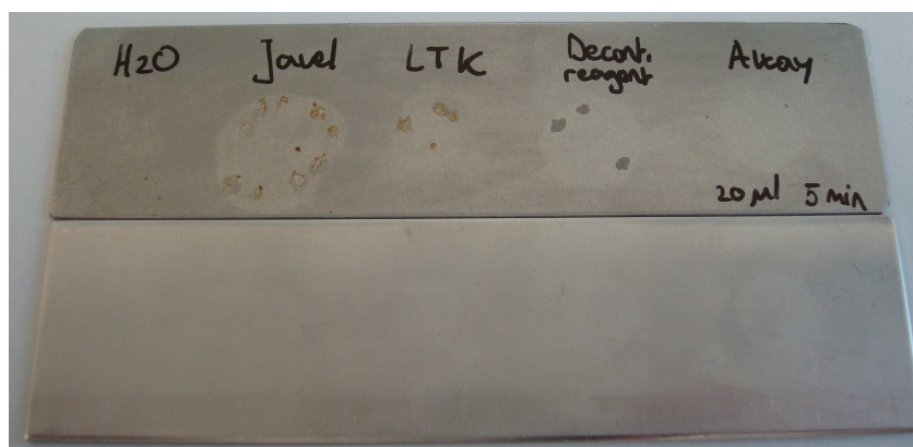
Tests de corrosion (5 min) des réactifs basiques sur l'acier (en haut) et l'acier inoxydable (en bas)
