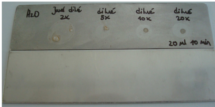
Figure 41: Tests de corrosion (10 min) de la Javel diluée 2x, 5x, 10x et 20x sur l'acier (en haut) et l'acier inoxydable (en bas)
