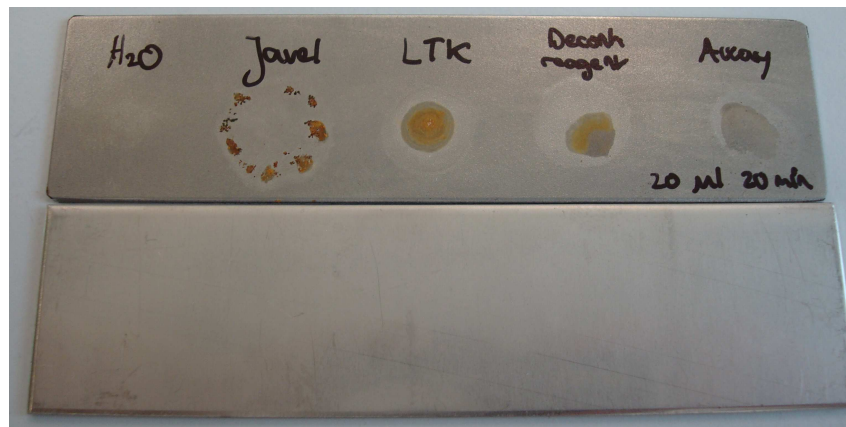
Tests de corrosion (20 min) des réactifs basiques sur l'acier (en haut) et l'acier inoxydable (en bas)
