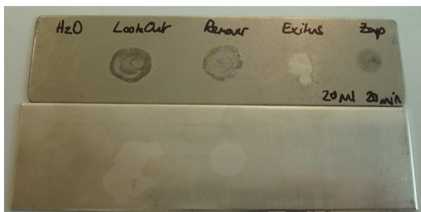
Tests de corrosion (20 min) des réactifs acides sur l'acier (en haut) et l'acier inoxydable (en bas)
