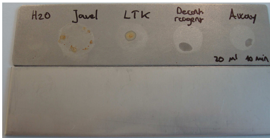
Figure 38: Tests de corrosion (10 min) des réactifs basiques sur l'acier (en haut) et l'acier inoxydable (en bas)
