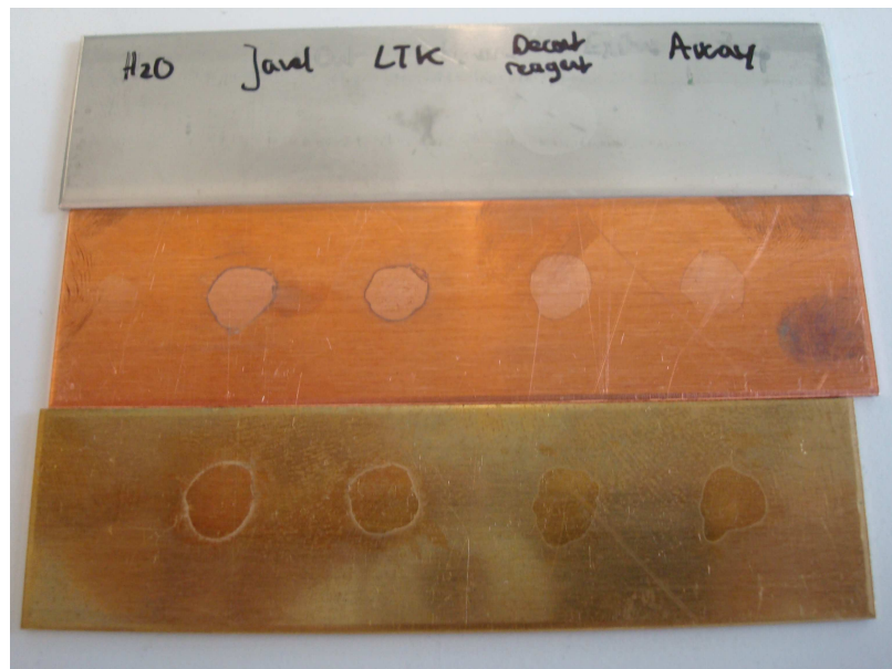
Tests de corrosion (20 min) des réactifs basiques sur l'aluminium (en haut), le cuivre (au milieu) et le laiton (en bas)
